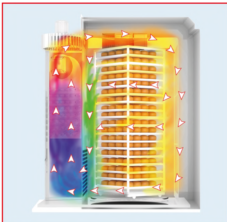
Схема движения воздуха в ротационной печи «Муссон-ротатор» модель 99/11-01
